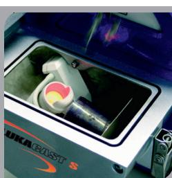
..... und in die Gießkammer gesetzt, dann den Deckel schlossen. Die Starttaste das 2. Mal drücken und das Vakuum startet. Nur kurze Zeit später ist das Metall geschmolzen.
