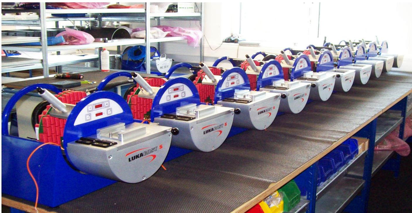
2007 haben wir das kleinste Vakuumdruckgussgerät der Welt - das LUKACast S (nur 27 kg), mit dem alle Dentallegierungen bis 2.000°C gegossen werden können, auf den Markt gebracht.
