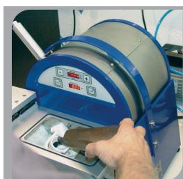
Das Metall wird in den Tiegel gefüllt, der dann in den Glaszyylinder gestellt wird. Die Starttaste wird 1 x gedrückt und die Aufheizung beginnt.
