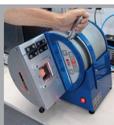
Dann kommt der geniale Dreh. Durch eine 90° Drehung der gesamten Gießeinheit wird in die Form abgegossen. Um den Guss zu optimieren, schaltet die Lukacast S nach dem Schwenk automatisch auf Überdruck um.
