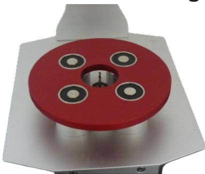
Netzstecker ziehen. Haltestift seitlich in ein Loch der Bohrachse stecken. Mit Rohrsteckschlüssel das Bohrfutter entgegen dem Uhrzeigersinn öffnen. Bohrer tauschen oder Bohrtiefe einstellen.
