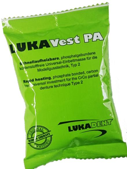
**LUKAVest PA** ist eine gipsfreie, phosphatgebundene Spezial-einbettmasse zur Herstellung von Duplikatmodellen und Gießformen für die CoCr-Modellgusstechnik. LUKAVest PA wird mit LUKAVest Liquid angemischt. Sie kann normal mit Haltezeiten getempert werden sowie als Speed direkt in den heißen Ofen bei 700°C - 900°C.
