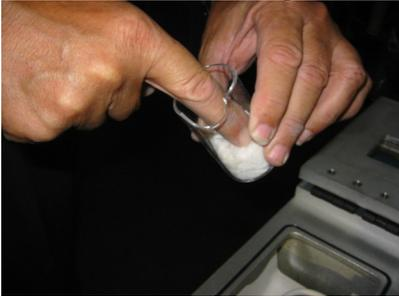
Der Tiegel sollte leicht auf dem Quarzvlies aufsitzen, der Tiegelkragen muss aber mit dem Tiegelschutzglas bündig sein.
