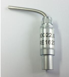
Blindstecker / Tiegelhalter zum fixieren des Tiegels und für das Nutzen der Leistungssteuerung anstatt der Temperaturregelung mit Thermoelement.
