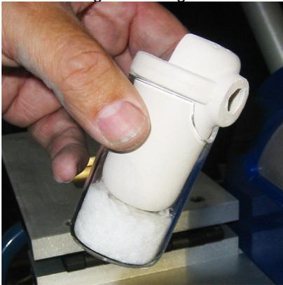
Tiegel mit Tiegelschutzglas in die Indukti-onsspule einsetzen.
